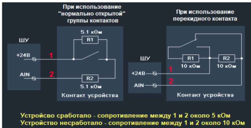
Рисунок 13 – Схема подключения резистора для обеспечения контроля линии.
