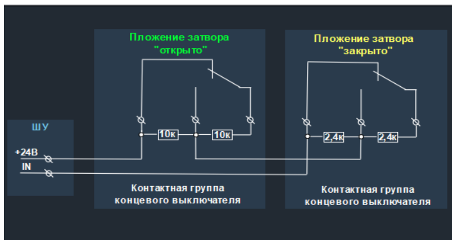
Рисунок 13 – Схема подключения резистора для обеспечения контроля линии поворотных затворов.
